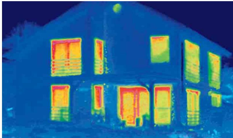
Nach dem sorgfältigen Einbau neuer Fenster aus dem Profilsystem Schüco CT 70 beweist die Thermografie den hohen energetischen Nutzen der Investition. Der ursprüngliche Energieverlust wird nahezu vollständig vermieden.
