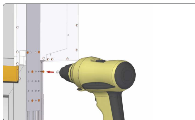
10. Przykręcić wcześniej przygotowane SUB-y w naznaczone otwory wkrętami dostarczonymi w komplecie.
